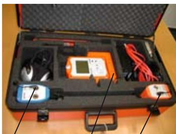
A l'intérieur de la valise, les câbles 2 et 4 doivent être raccordés aux deux émetteurs **RT 06** et le câble 3 à la station d'accueil HS 1,2 A.
